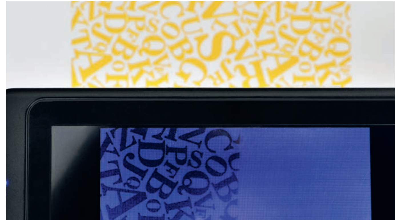
IR-Absorption auf dem Kamerabildschirm erkennbar
